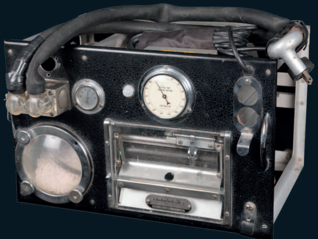
Metabulator, equipo para medición del metabolismo basal
