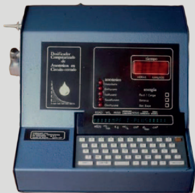
▲ Vaporizador microcompensado desarrollado por el Dr. Parra en la Facultad de Ingeniería de la Universidad Javeriana
